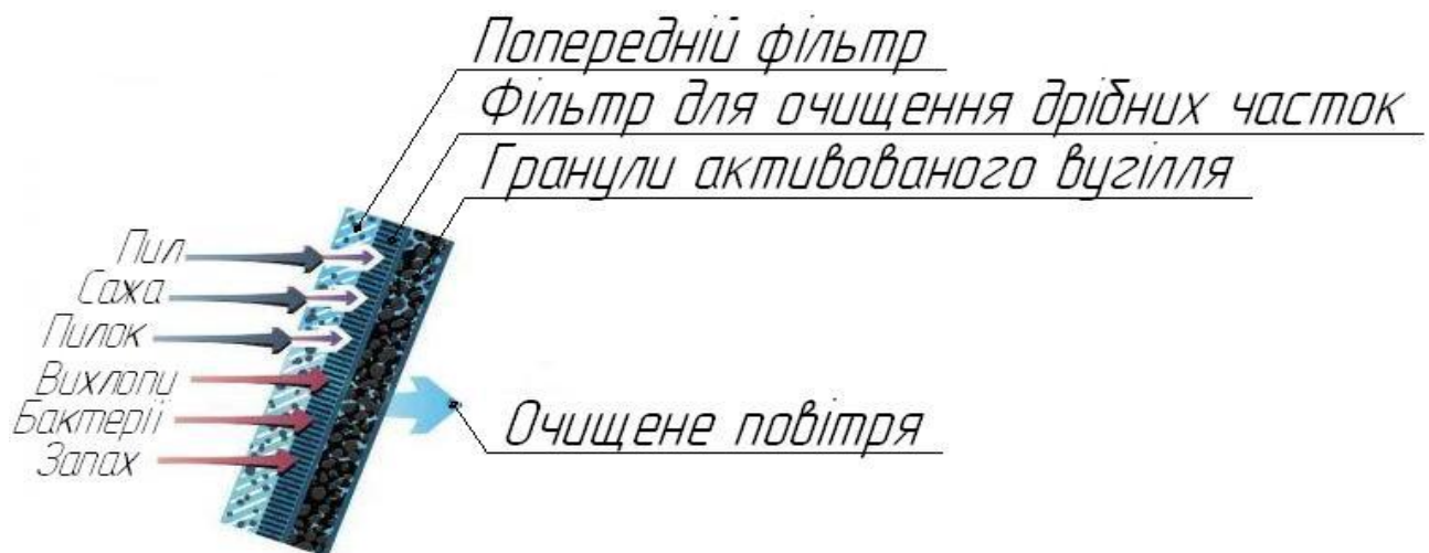
Рис.1. Принцип дії фільтру по очищенню повітря у салоні автомобіля
