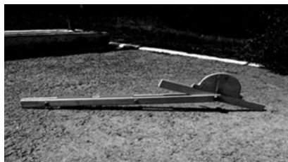
Рис. 1. Приклади підтоплення в м. Кам'янець-Подільський: а – стікання ливневих вод з вулиць міста; б – прилад «Ухиломір»
